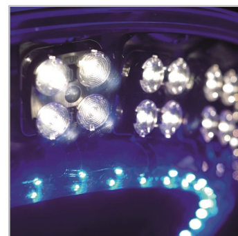
Układ optyczny składa się z 64 białych diod Led w grupach po 16 modułów, które umożliwiają ich niezależne nakierowanie w zależności od wymaganej sytuacji oświetleniowej.
